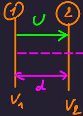
On a:  $\vec{E} = \frac{V_1 - V_2}{d} \vec{e}_x$
